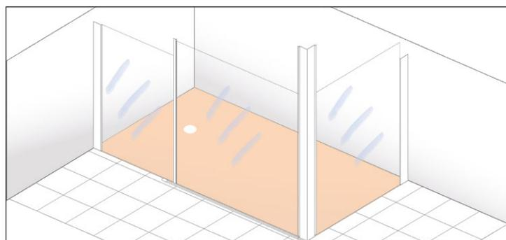
EN LOS PLATOS A RAS DE SUELO (ENCASTRADOS), SI SE DESEA QUE EL VIDRIO COINCIDA CON LA JUNTA DE UNIÓN DEL PLATO AL SUELO, HAY QUE INDICARLO EN EL PEDIDO PARA QUE SE FABRIQUE A LA DIMENSIÓN CORRECTA.
