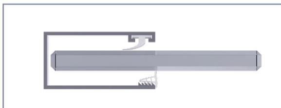
**LOS PERFILES EXPANSORES DE 32 X 17MM OFRECEN UNA EXPANSIÓN DE HASTA 2 CM.**
