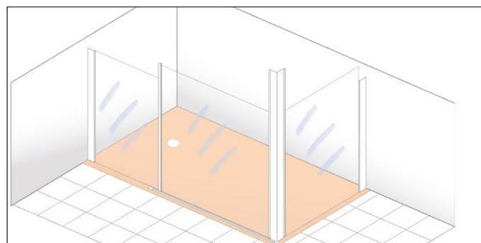
PLATO NO COINCIDE CON LA JUNTA DE UNIÓN PLATO-SUELO. (POR DEFECTO SI NO SE INDICA EN EL PEDIDO)
