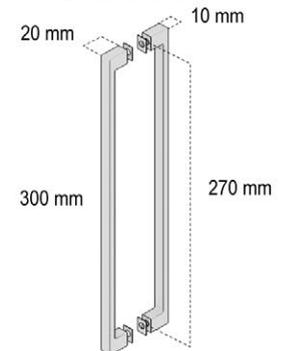
**BARRA DE SUJECCIÓN (MONTAJE)**
