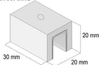
**BARRA DE SUJECCIÓN (MONTAJE)**
