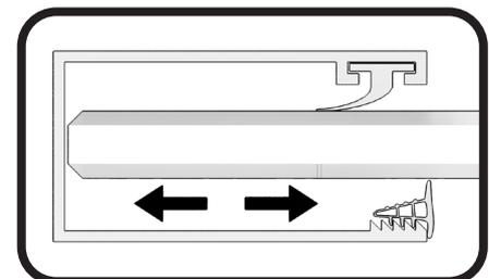
AJUSTAR EL JUEGO DE LOS VIDRIOS FIJOS SEGÚN NECESIDAD. FIJAR EL VIDRIO, ENGOMANDO EL CRISTAL CON EL PERFIL A PARED Y CON LA GUIA SUPERIOR.
