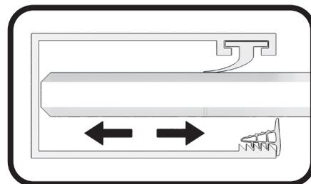
AJUSTAR EL JUEGO DE LOS VIDRIO FIJO SEGÚN NECESIDAD. FIJAR EL VIDRIO, ENGOMANDO EL CRISTAL CON EL PERFIL A PARED Y CON LA GUIA SUPERIOR.
