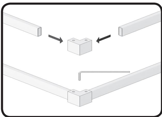
MONTAR CODO UNIÓN GUÍAS.
